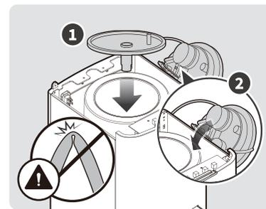
11 バッフルと冷水タンクのカバーをエアークンシリコンチューブが折れないように気を付けながら設置してください。
