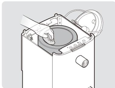
8 冷水タンク底面にある残水をきれいな布で拭いた後、やわらかい布に適量のアルコールをつけて冷水タンクの内部をきれいにふき取ってください。
