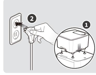
13 貯水タンクに水道水を満タンにし、トップカバーを取りつけて、電源コードを挿します。
