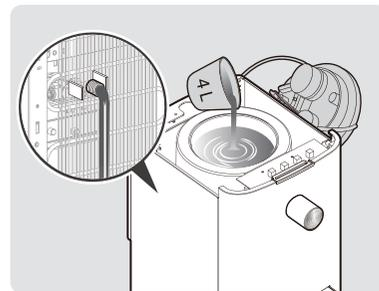
10 事前に排水キャップの下に容器を用意してください。排水キャップを開けて水を完全に排出させてから排水キャップを閉めてください。4リットルの水をもう一度入れた後、排水キャップを開けて完全に排出させてから排水キャップを閉めます。この手順を3回以上繰り返し、内部をきれいに洗淨します。
