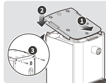
12 トップカバーの手前のところを製品の後ろから押し込み、後ろのところを下へ押します。その後、2つのねじでトップカバーを固定します。
